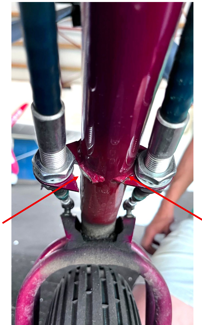
Obrázek 1 Přední podvozková noha s ulomenými úchyty teleflexů.
