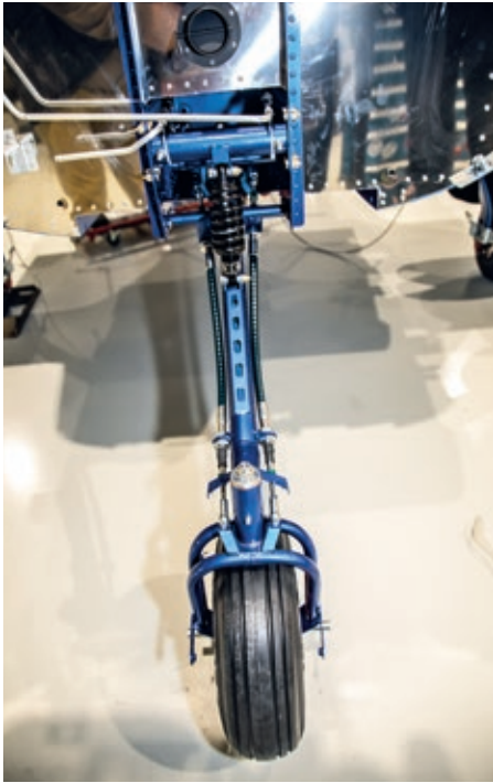
Gelenkt Das Bugrad ist über flexible Züge angesteuert, ein Federbein stützt die geschobene Schwinge ab
