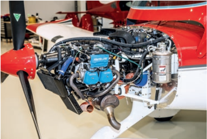
Das Maximum Zurzeit ist die B23 mit dem 100-PS-Vergasermotor von Rotax zugelassen. Sie fliegt aber bereits mit dem hier montierten 915 iS (141 PS)
