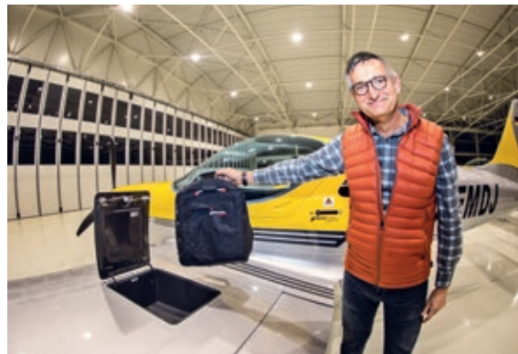
Passgenau Für die Gepäckfächer in der Tragfläche werden spezielle Taschen angeboten. Beide Seiten dürfen mit jeweils 20 Kilo beladen werden
