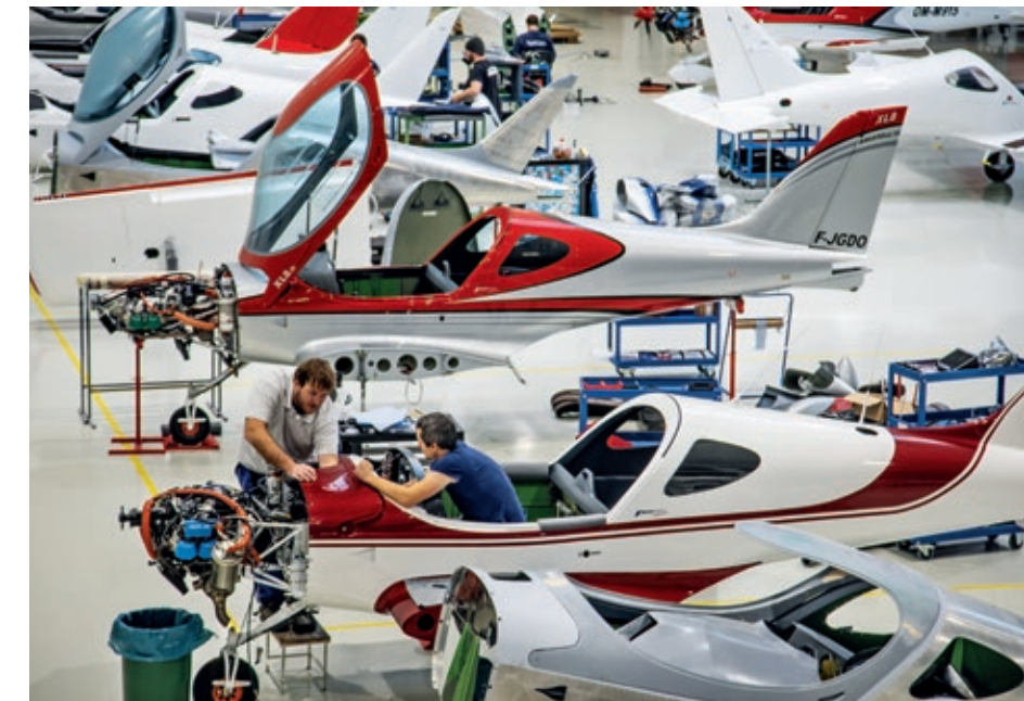
Serienproduktion Jeden Monat fertigen 90 Mitarbeiter zwölf Flugzeuge dreierlei Typs. Insgesamt hat BRM Aero bis Ende vorigen Jahres 625 Maschinen gebaut
