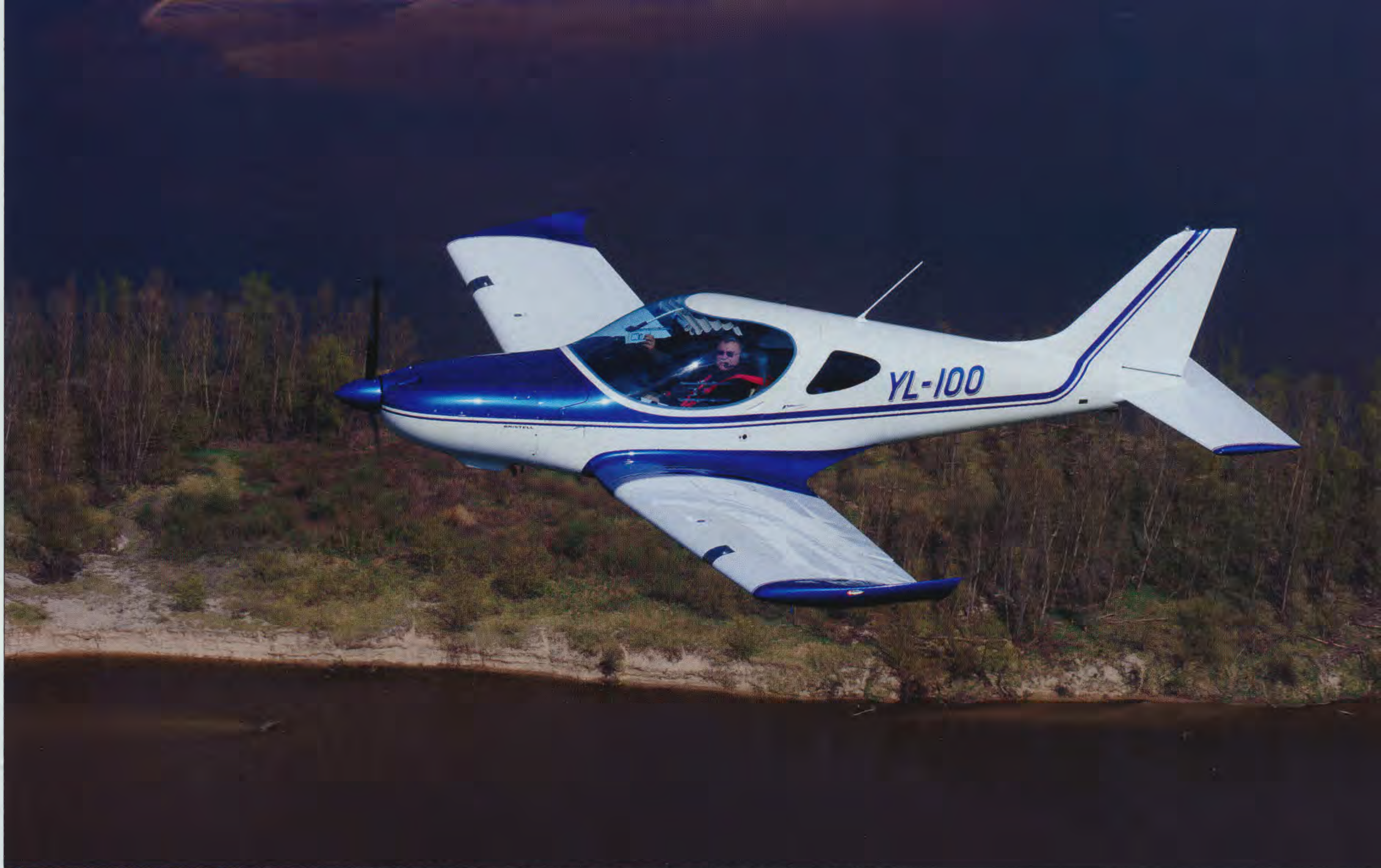
Na parametrach przelotowych (5000 obr/min), prędkość CAS wynosi 216 km/h, zużycie paliwa 20,8 l/h a zasięg 1670 km
