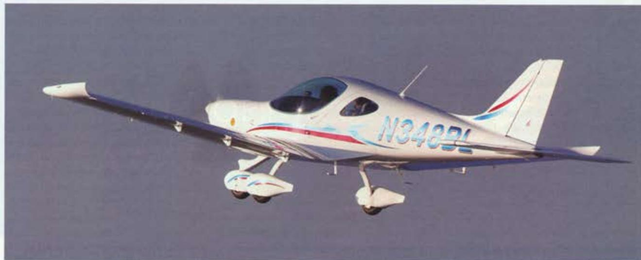
шасси с носовой стойкой, управляемой от педалей, или трехопорное шасси с хвостовым колесом. На колеса возможна установка обтекателей, колеса также устанавливаются различного диаметра в зависимости от качества взлетно-посадочных полос, с которых планируется чаще всего летать. Также возможна установка лыж и поплавков для эксплуатации с водоемов. Конструкция шасси рассчитана для работы с грунтовыми аэ-
